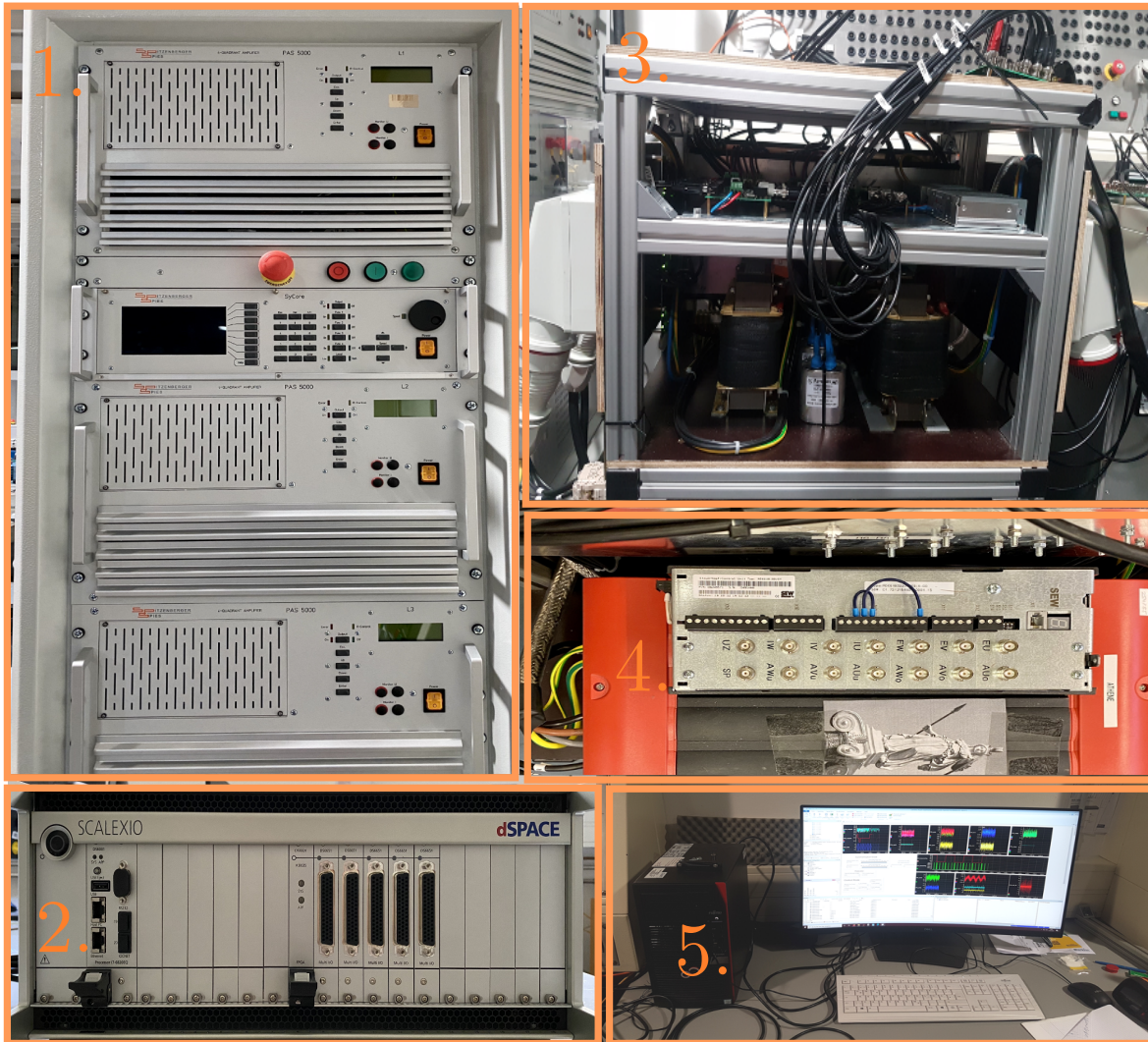
Abbildung 22: Aufbau des netzseitigen Prüfstands im LMRES mit 1. Spitzberger Spies Netzemulator; 2. dSPACE-SCALEXIO Echtzeitsystem; 3. LCL-Filter; 4. Zweistufiger SEW-Umrichter und 5. Host-Rechner.
