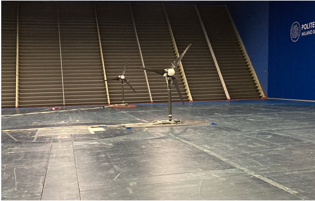
Abbildung 99: Versuchsaufbau im Windkanal. Es sind die mittlere und hintere Turbine auf der Drehscheibe zu sehen.
