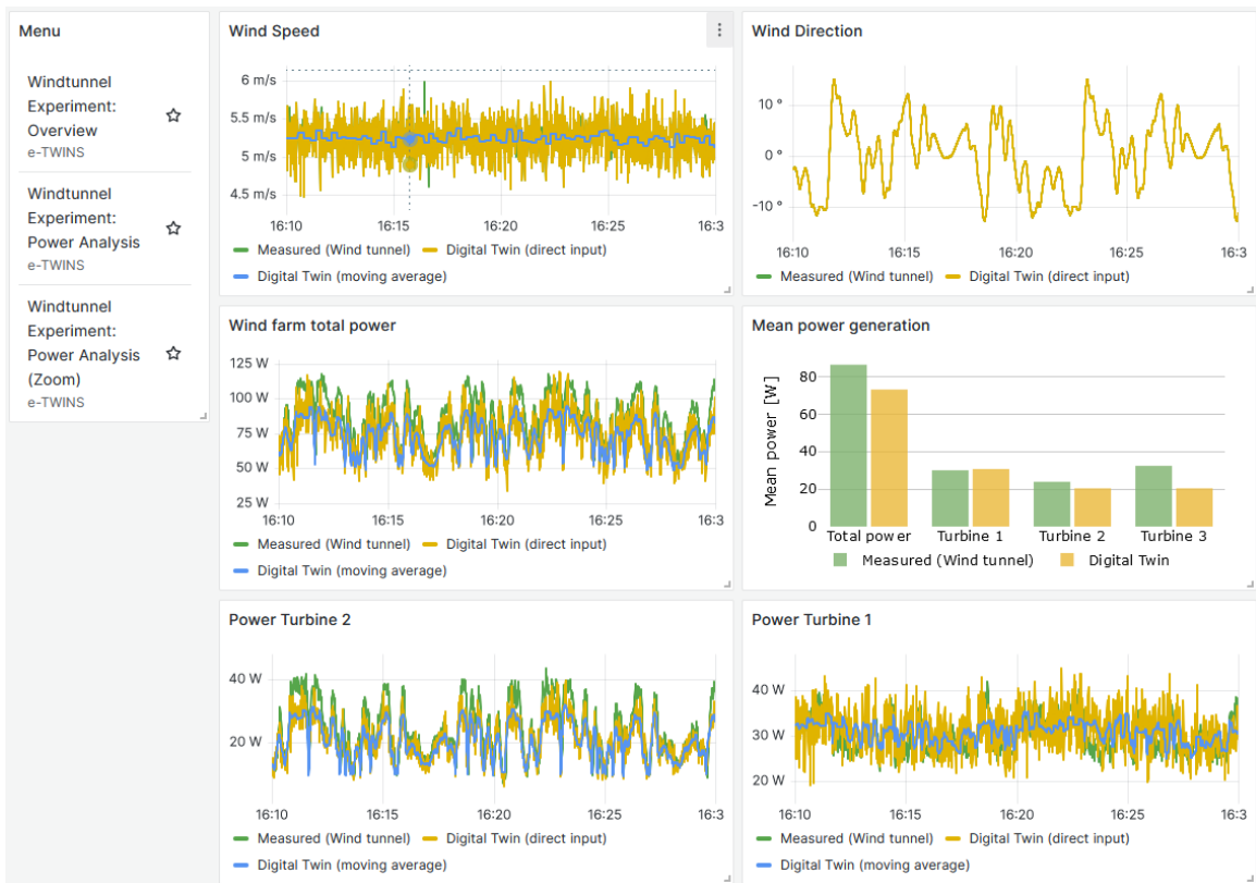
Abbildung 5: Beispiel eines mit Grafana erstellten Dashboards für die Visualisierung der Daten aus dem Software-Framework.
